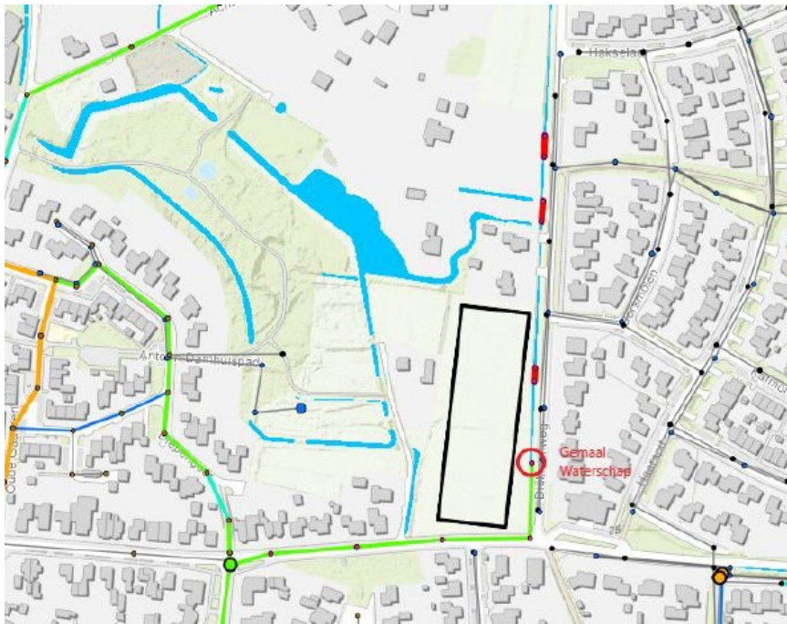
Figuur 6 Bestaande riolering (Noaberkracht, 2022)
