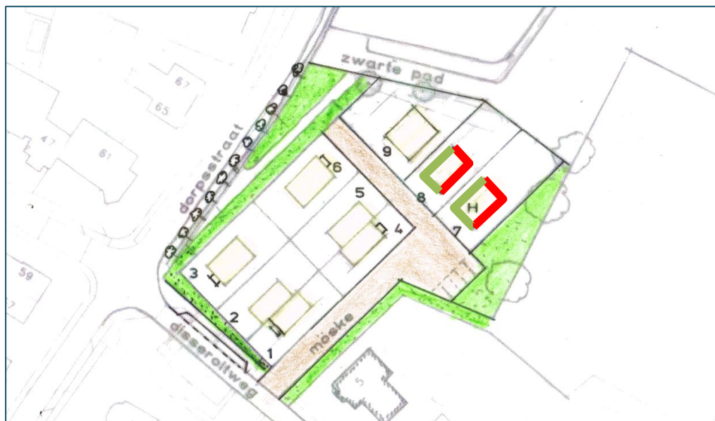
Figuur 4 Hoger belaste en minder belaste geveldelen
