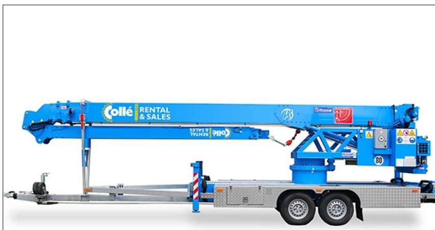
Voorbeeld van een lichte, mobiele kraan. Geschikt voor aanreiken dakpannen.
