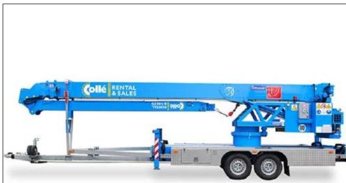
Voorbeeld van een lichte, mobiele kraan. Geschikt voor aanreiken van sandwichpanelen, kozijnen en glas.
