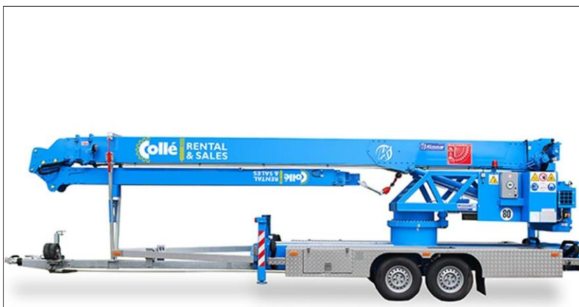
Voorbeeld van een lichte, mobiele kraan. Geschikt voor plaatsen dakplaten, gordingbalken en aanreiken dakpannen.
