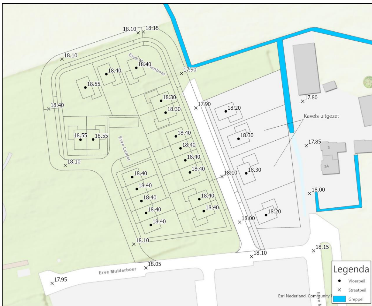
Afbeelding 3.5: Straat- en vloerpeilen fase 4
