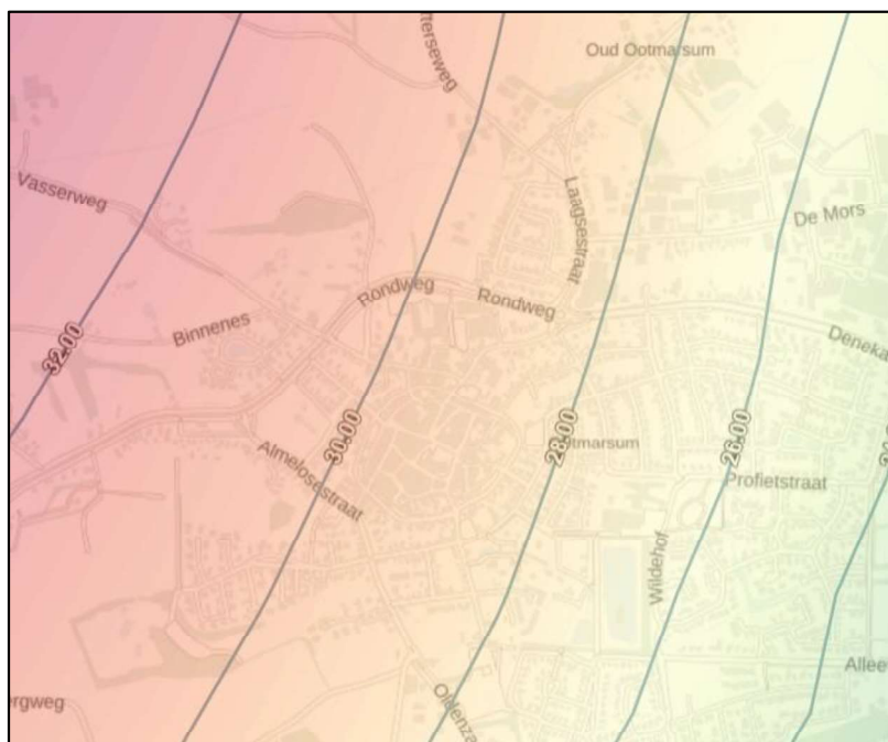
Figuur 4.5: Grondwaterstroming m + NAP (Grondwatertools; isohypsen 1 e watervoerend pakket)
