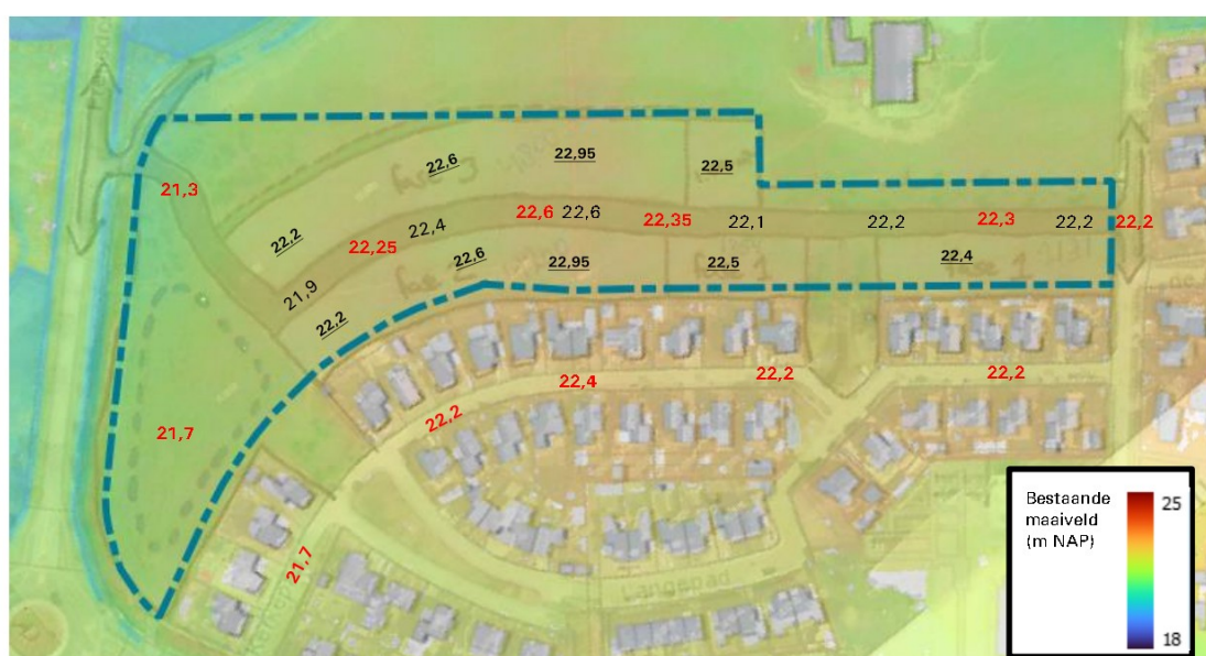
Figuur 6.1: Voorstel bouwpeilen/ vloerpeilen
