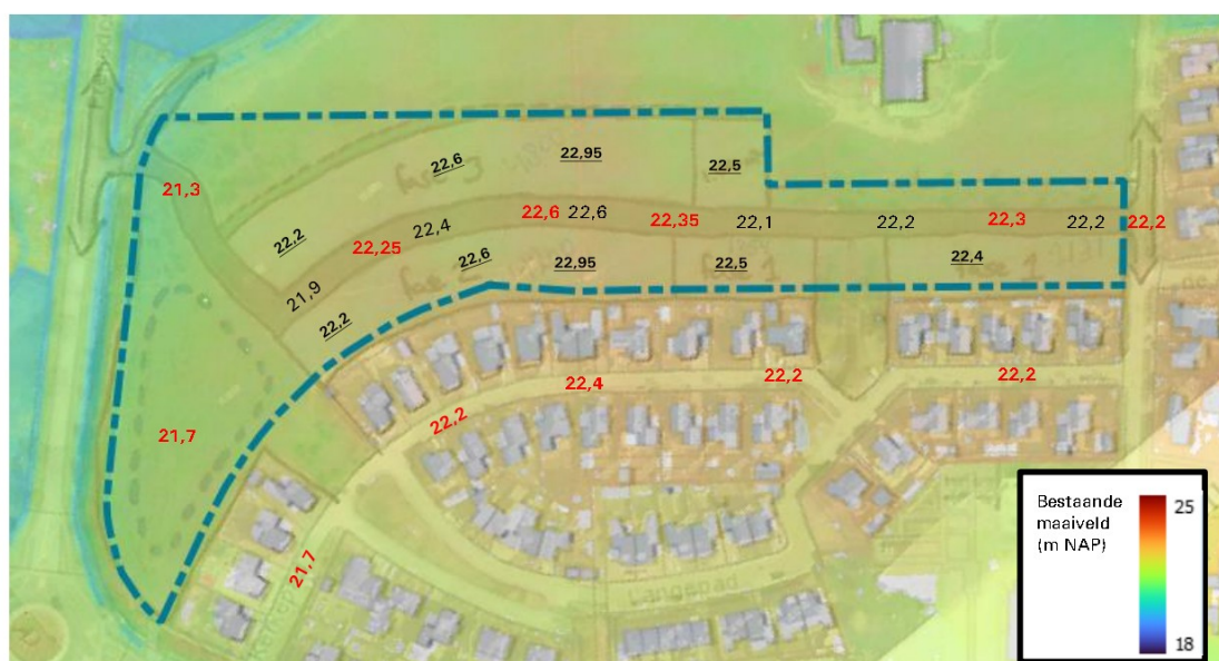
Figuur 6.1: Voorstel bouwpeilen/ vloerpeilen
