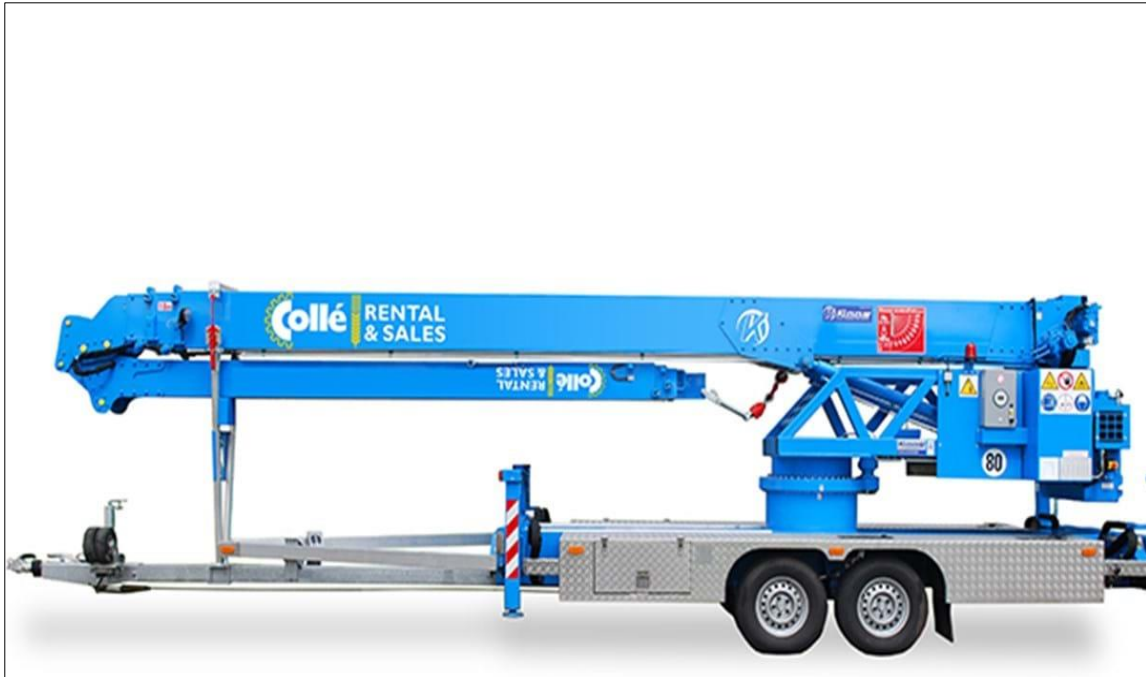
Voorbeeld van een lichte, mobiele kraan. Geschikt voor aanreiken dakpannen, gevelbekleding, kozijnen en glas.
