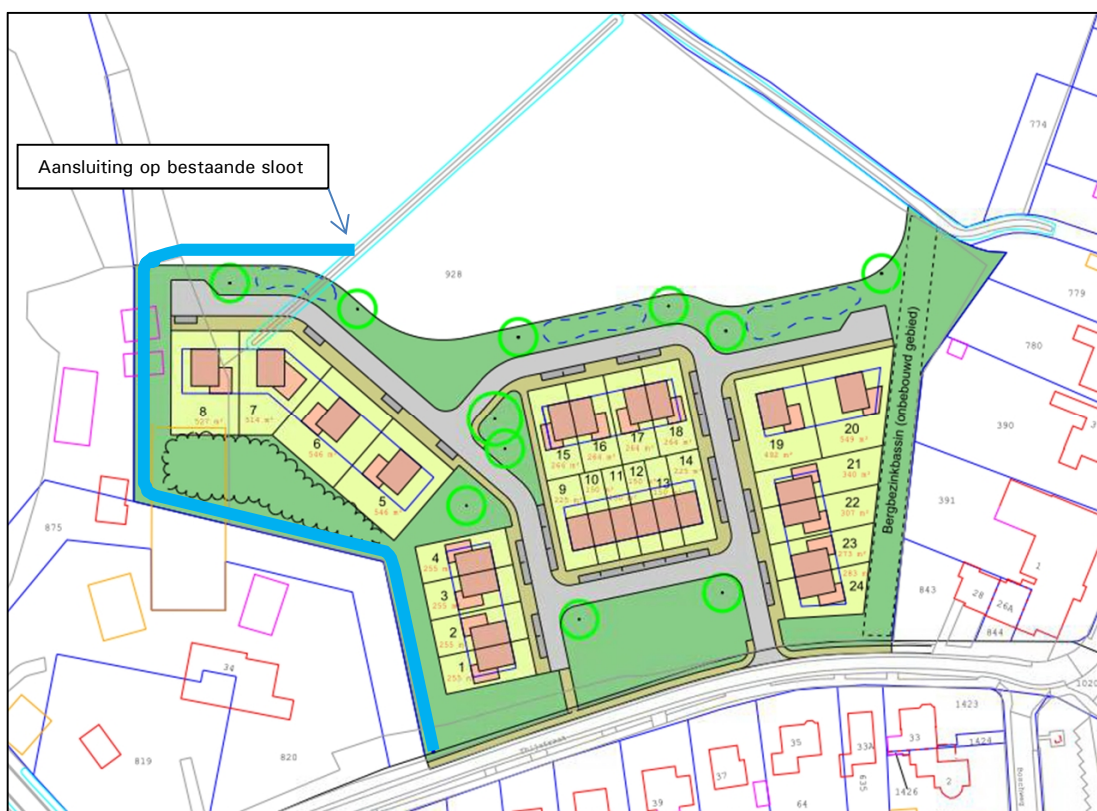
Figuur 5.3: Nieuwe watergang westzijde plangebied, aangesloten op bestaande sloot
