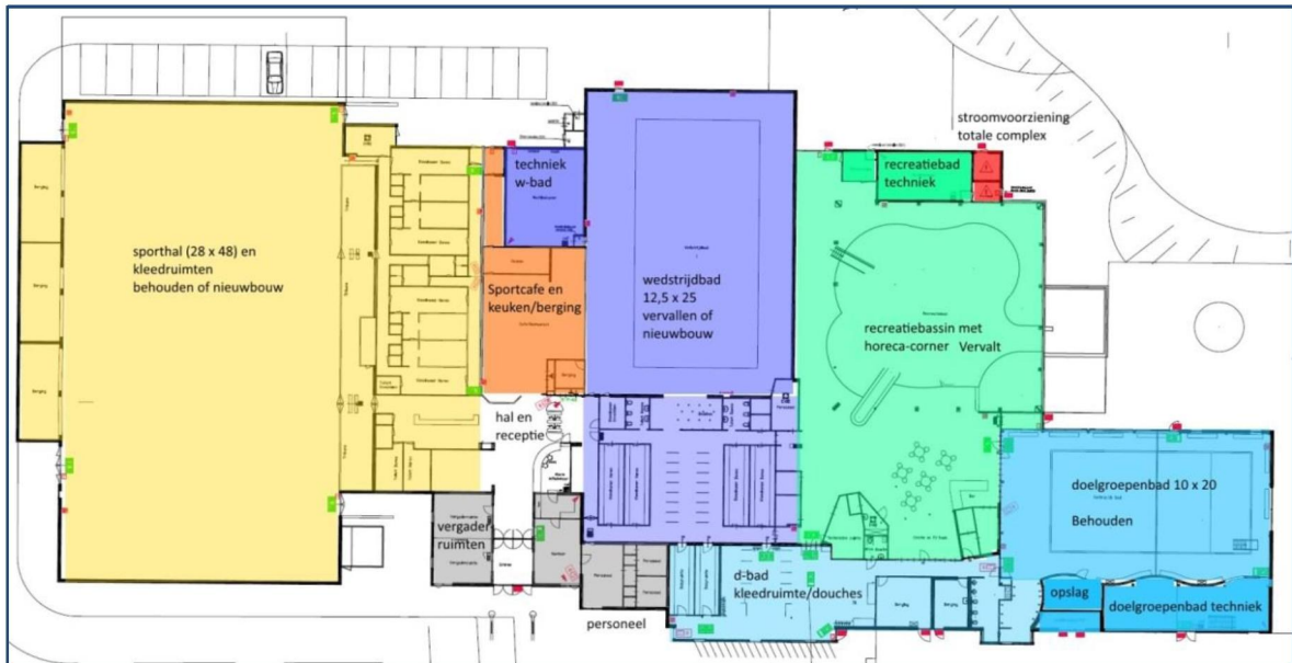
Optie 0: behoud van het bestaande complex
